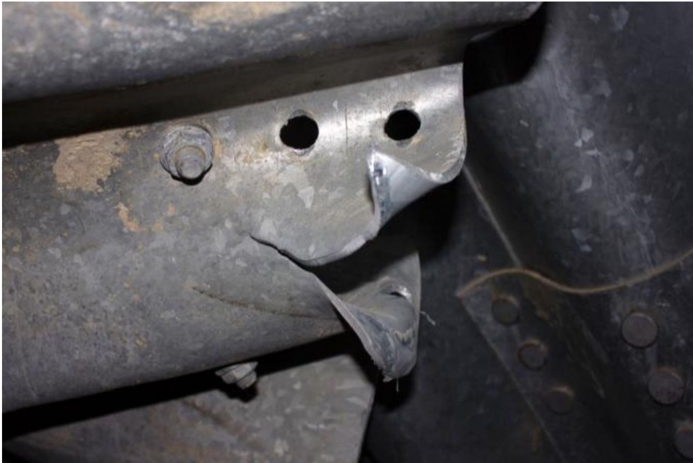
Разрыв металла пластин в месте продольного стыка.
