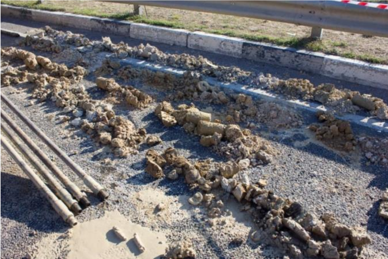
Грунт насыпи из контрольной скважины.
